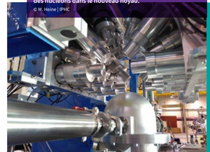
STELLA détecte, d'une part les particules (proton ou alpha) émises lors de la fusion de deux noyaux et, d'autre part, le rayonnement gamma émis lors du réarrangement des nucléons dans le nouveau noyau. © M. Heine | IPHC
