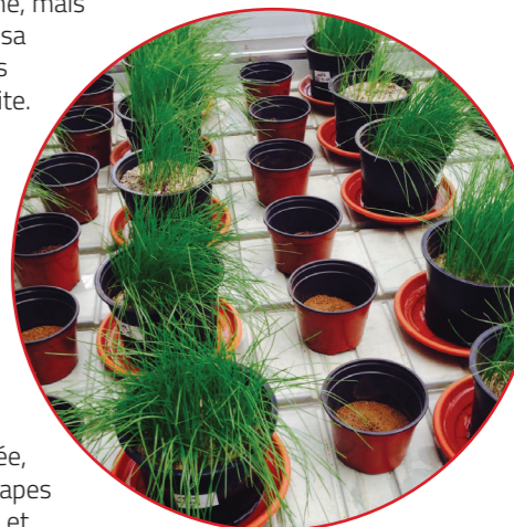
Tests de biofertilisants obtenus par le procédé de valorisation des déchets issus de la production d'huile d'olive. © Mejdi Jeguirim
